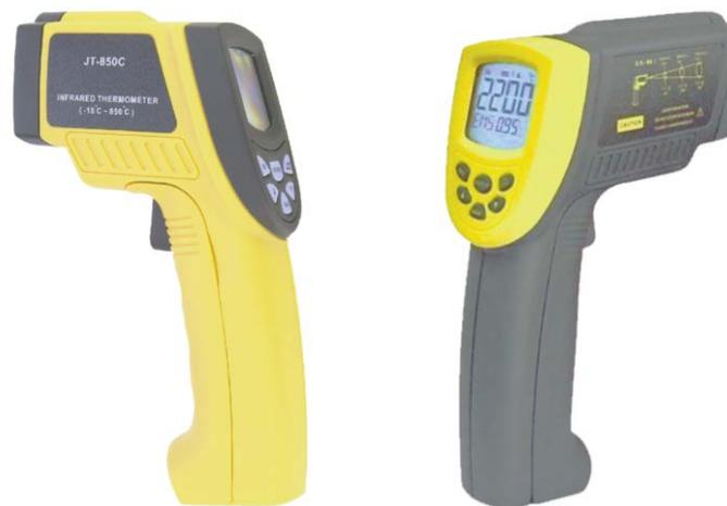
Los termómetros digitales IT se manejan con facilidad, sólo tiene que apuntar el láser a la superficie deseada y presionar el boton de lectura, la temperatura aparecera instantaneamente en °C o °F . Su ratio de medida varia según el modelo llegando a 12:1 en el IT-850 lo que permite lecturas a gran distancia.
